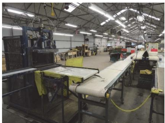
土の充填と種撒き用の機器
