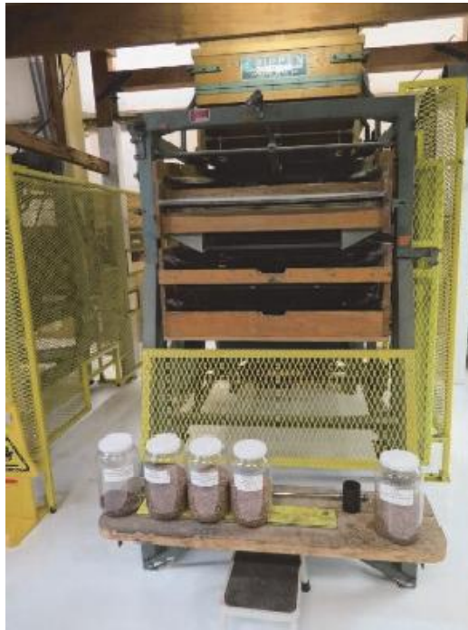
スクリーンフィルター型の分離機
