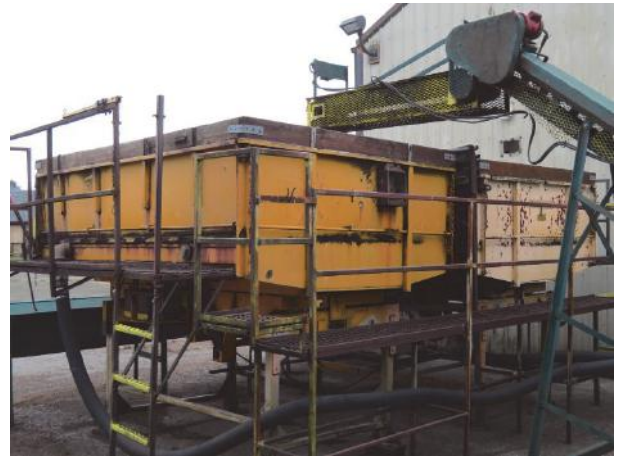
土の蒸気殺菌装置
