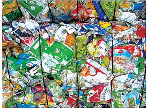
選別された紙パック 1 ベール (紙) = 600kg 紙パックの中にプラスチックも混入しているが、5%まで混入 OK としている。
