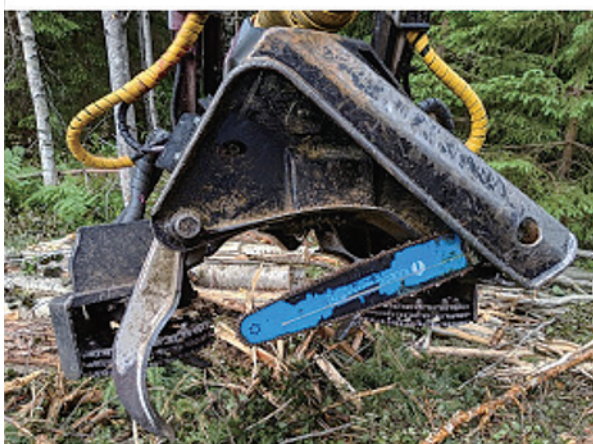
チェーンソー 径の計測用のセンサーがついている
