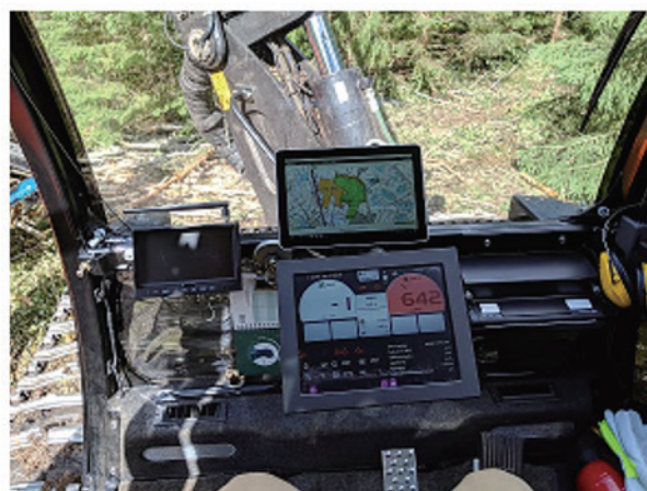
重機のコックピット GPS や木材量の計測結果が表示
